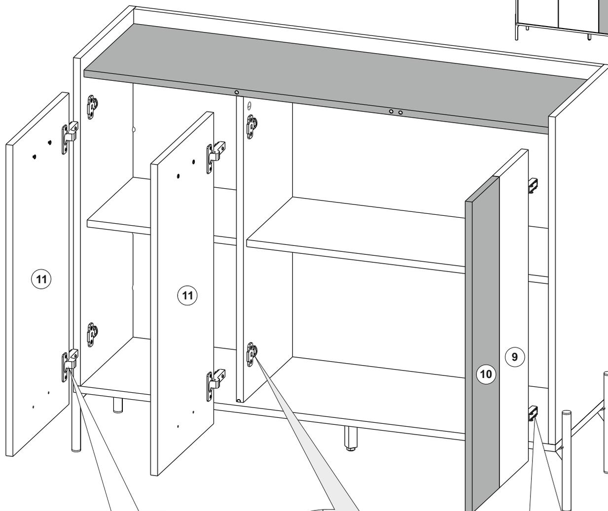
Регулирование зазоров и положения фасада
