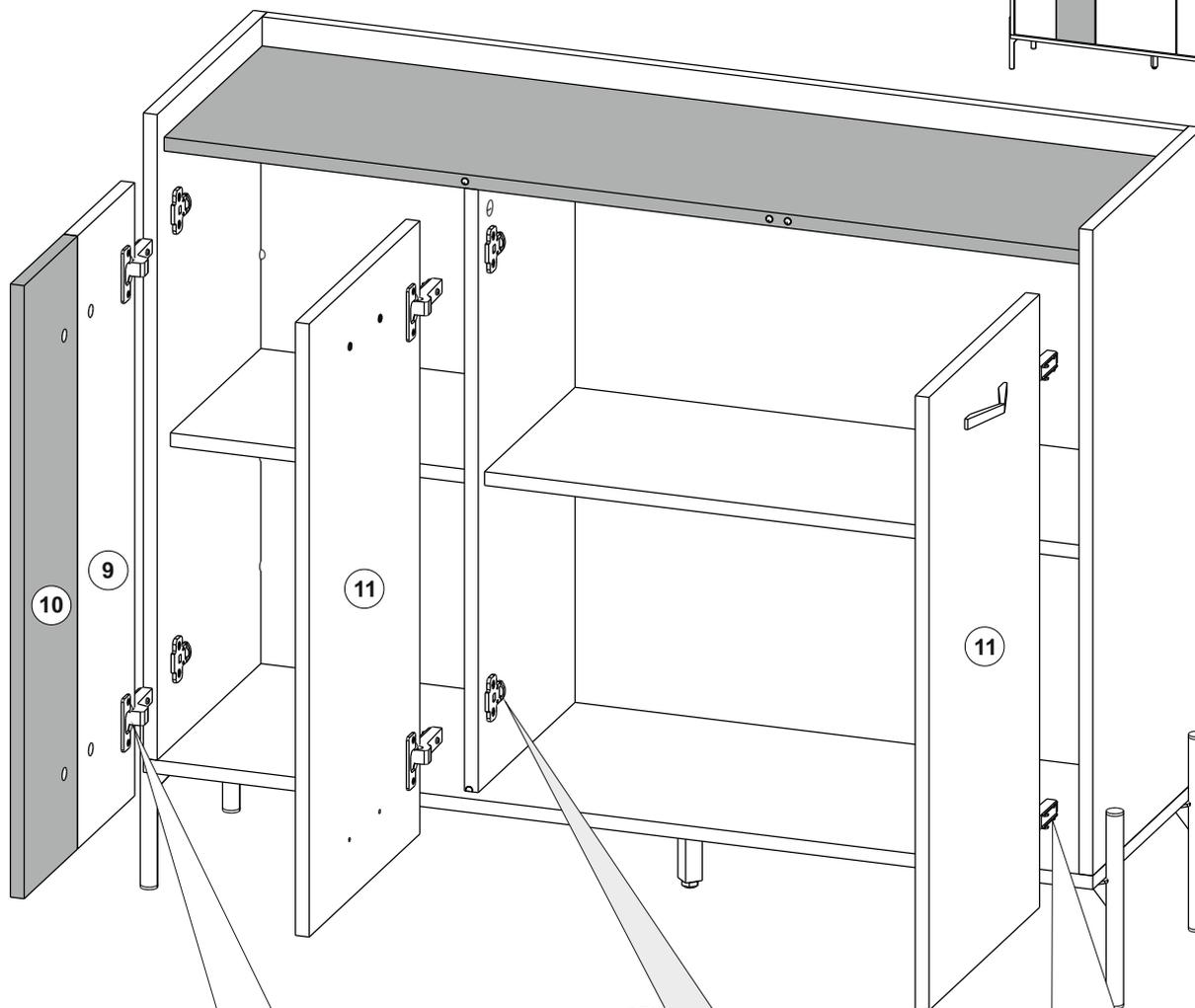
Регулирование зазоров и положения фасада
