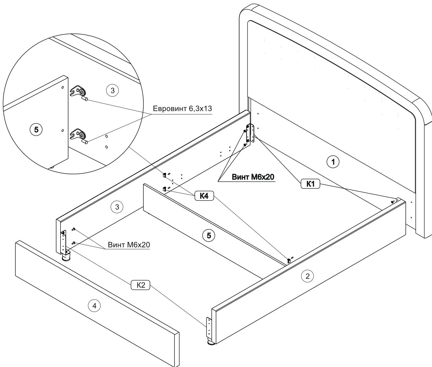
**Схема 3. Установка элементов подъемного основания ортопедического**
