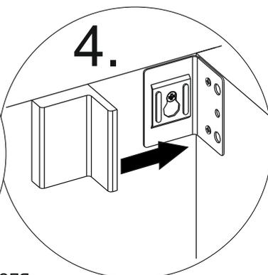
\*Подбирайте тип крепежа и дюбеля в зависимости от материала стен
