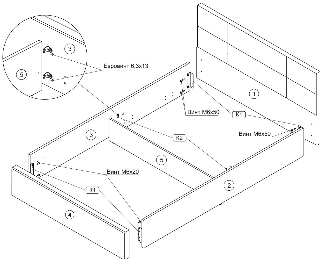
**Схема 3. Установка элементов подъемного основания ортопедического**
