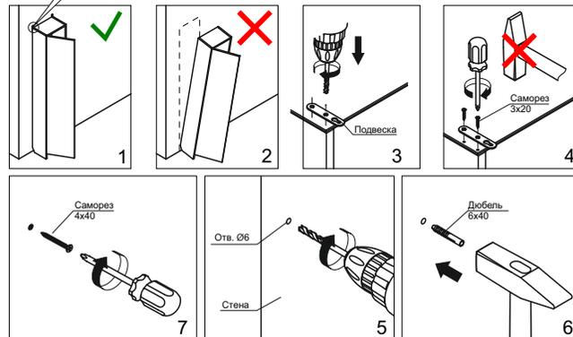
Во избежание опрокидывания изделия во время эксплуатации закрепить его к стене (см. схемы 1, 2). Для разных материалов стен требуются различные крепления, используйте крепёжные средства, подходящие для материала стен в вашем доме. На схемах 3 - 8 показана последовательность крепления изделия к стене с использованием дюбелей.
